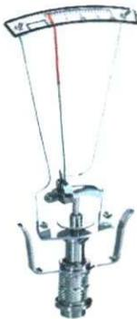
Gambar 1.5 Tonometri Schiotz
