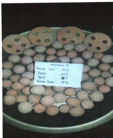
Gambar 2.5 Membran Keramik E
