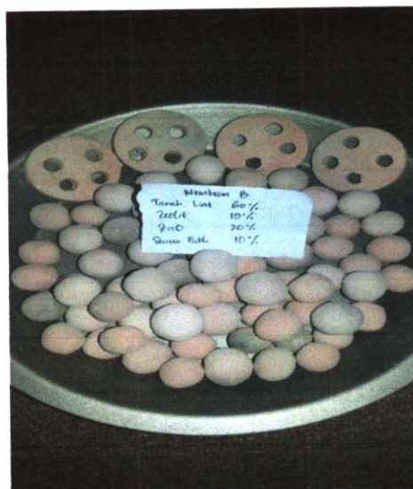
Gambar 2.2 Membran Keramik B
