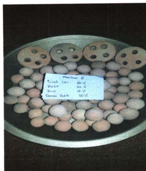
Gambar 2.4 Membran Keramik D
