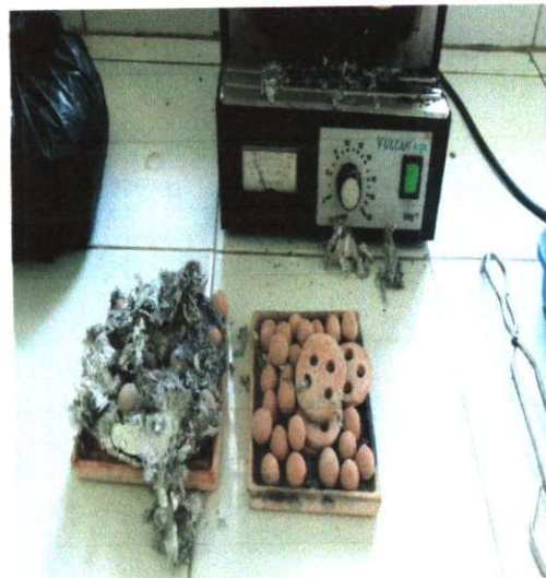
Gambar 1.7 Membran Keramik Dibakar
