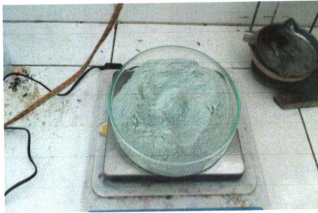
Gambar 1.4 Bahan Zeolit yang telah dihaluskan dan disaring
