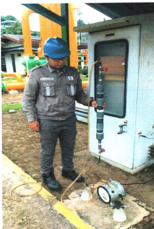
Gambar 3.1 Rangkaian Alat dan Pengambilan Sampel Gas
