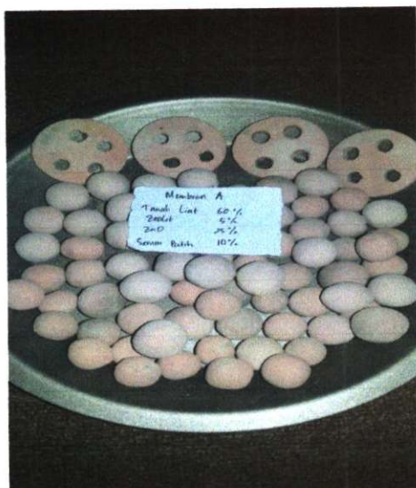
Gambar 2.1 Membran Keramik A
