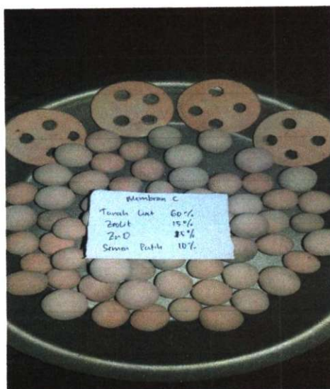
Gambar 2.3 Membran Keramik C
