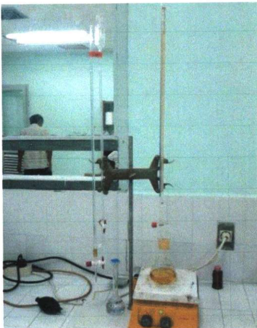
Gambar 4.1 Rangkain Alat Titrasi
