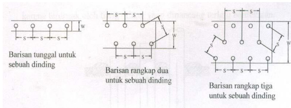
Gambar 2.2 Pola-pola pondasi kelompok tiang pancang
