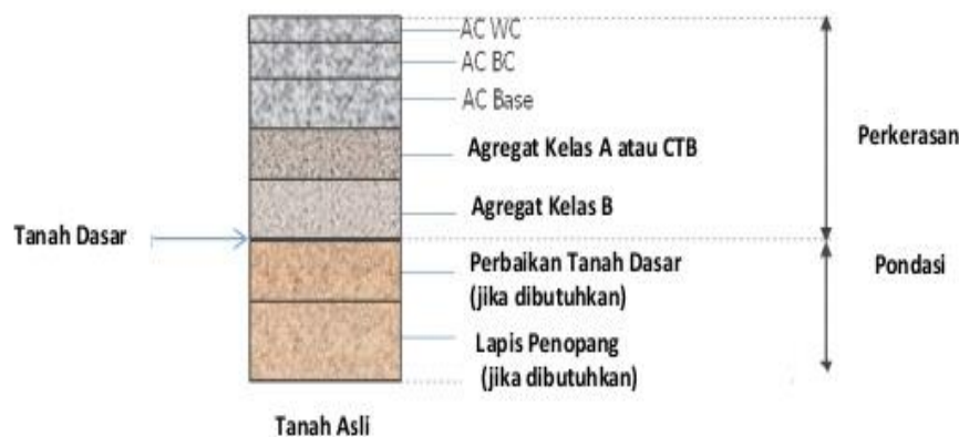
Gambar 2.2 Konstruksi Perkerasan Lentur
