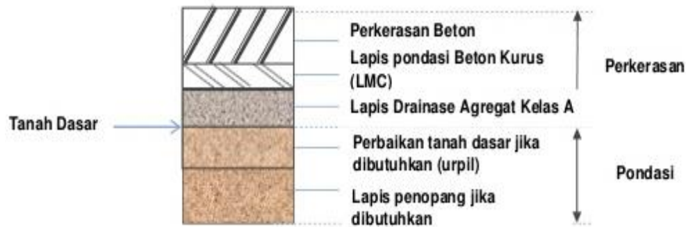
Gambar 2.3 Konstruksi Perkerasan Kaku
