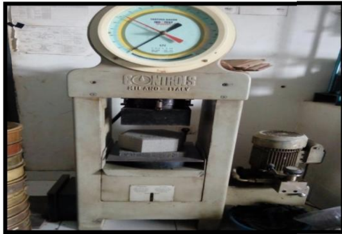
Gambar 3.12 Mesin uji kuat tekan beton
