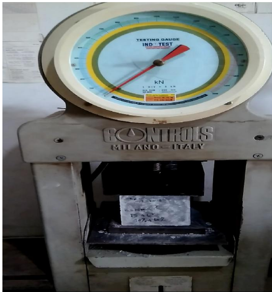
Foto 3. Pengujian Kuat Tekan Beton
