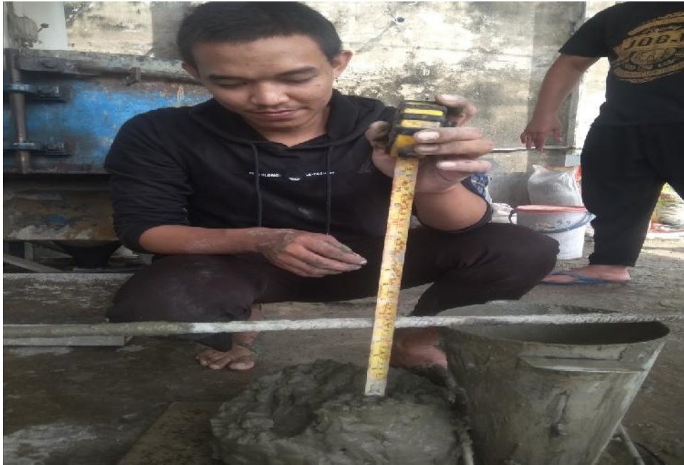
Foto 2. Pemeriksaan Slump Test
