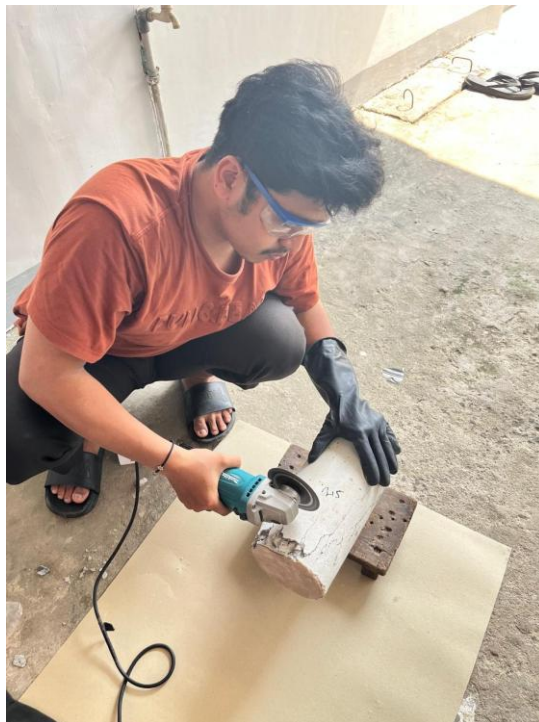
Pemotongan Beton Yang Berumur 28 Hari
