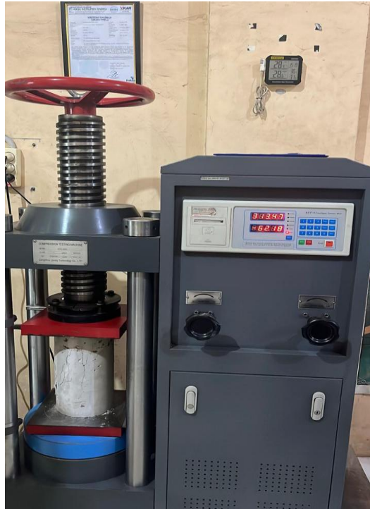
Pengujian Kuatb Tekan Beton Berumur 28 hari
