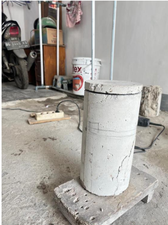
Beton Yang Siap Untuk di Potong
