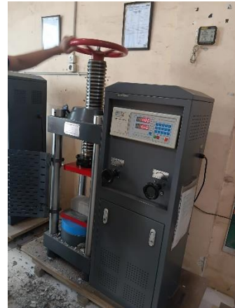
Gambar 3.31 Pengujian Kuat Tekan
