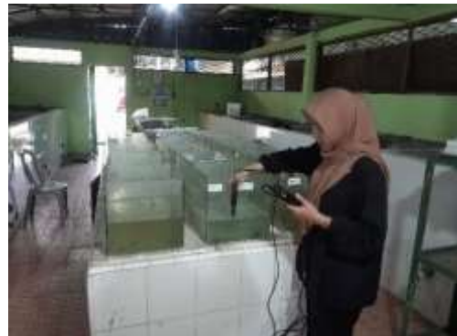
10. Pengukuran DO Meter
