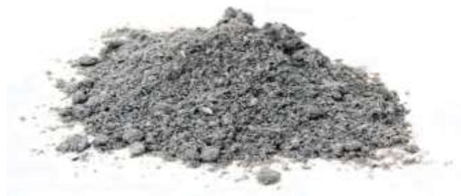
Gambar 2. 2. Limbah padat karbit dalam kondisi basah
