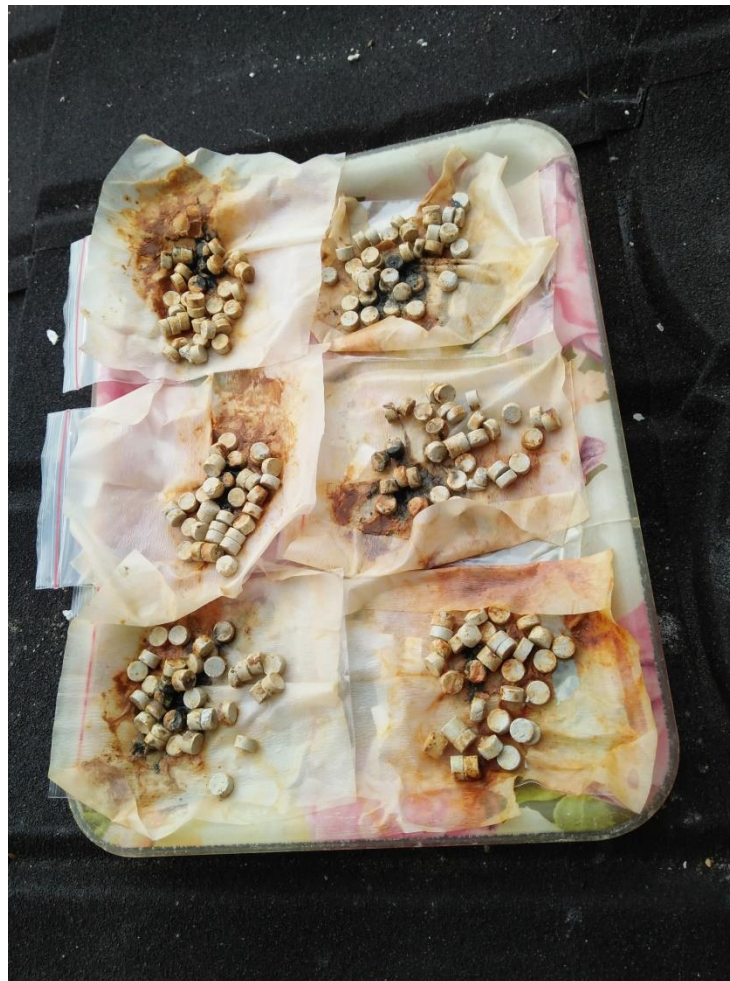
6) Limbah karbit berupa tablet yang telah mengadsorpsi ion logam Fe di jemur untuk uji sem
