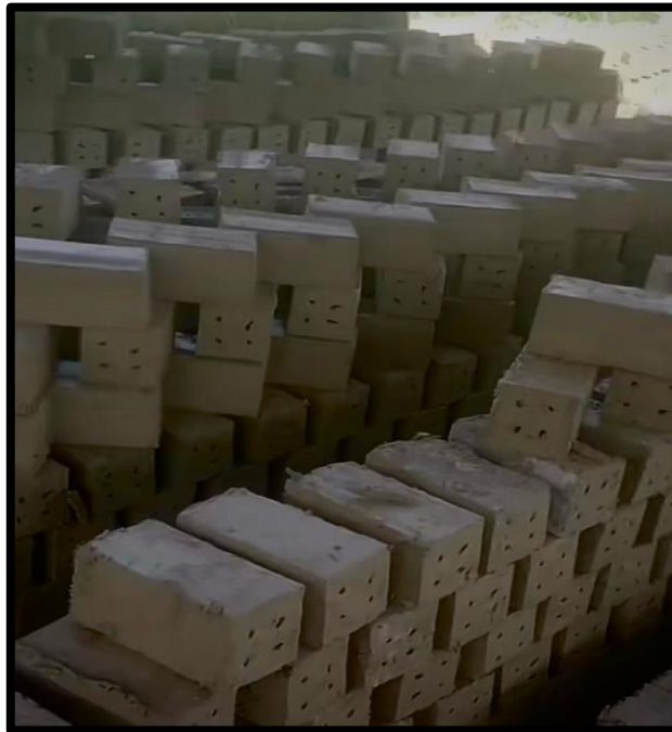
Gambar 4.4 Pengeringan Batu Bata Mentah
