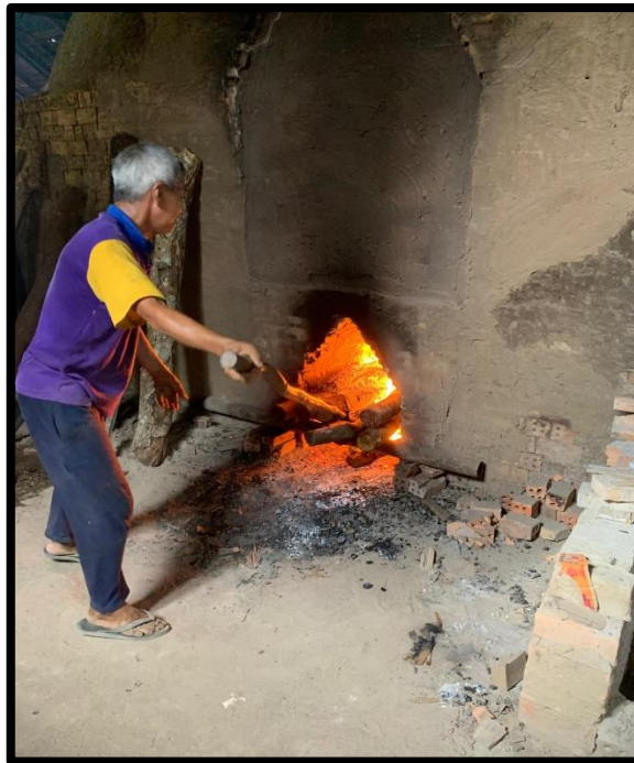
Gambar 4.5 Pembakaran Batu Bata
