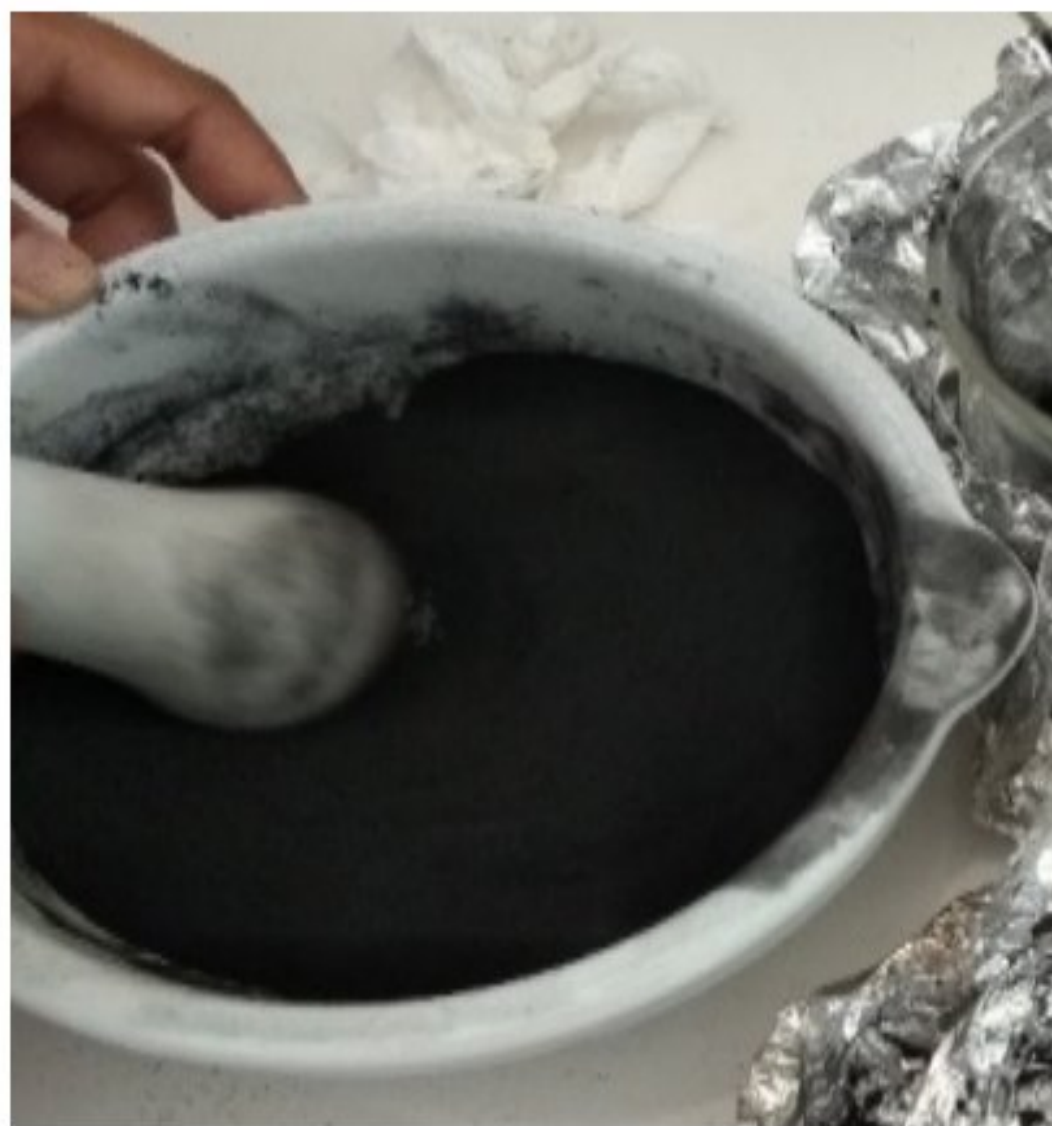
Gambar 4 Penghalusan karbon aktif sebelum direndam dengan aktivator H 2 SO 4
