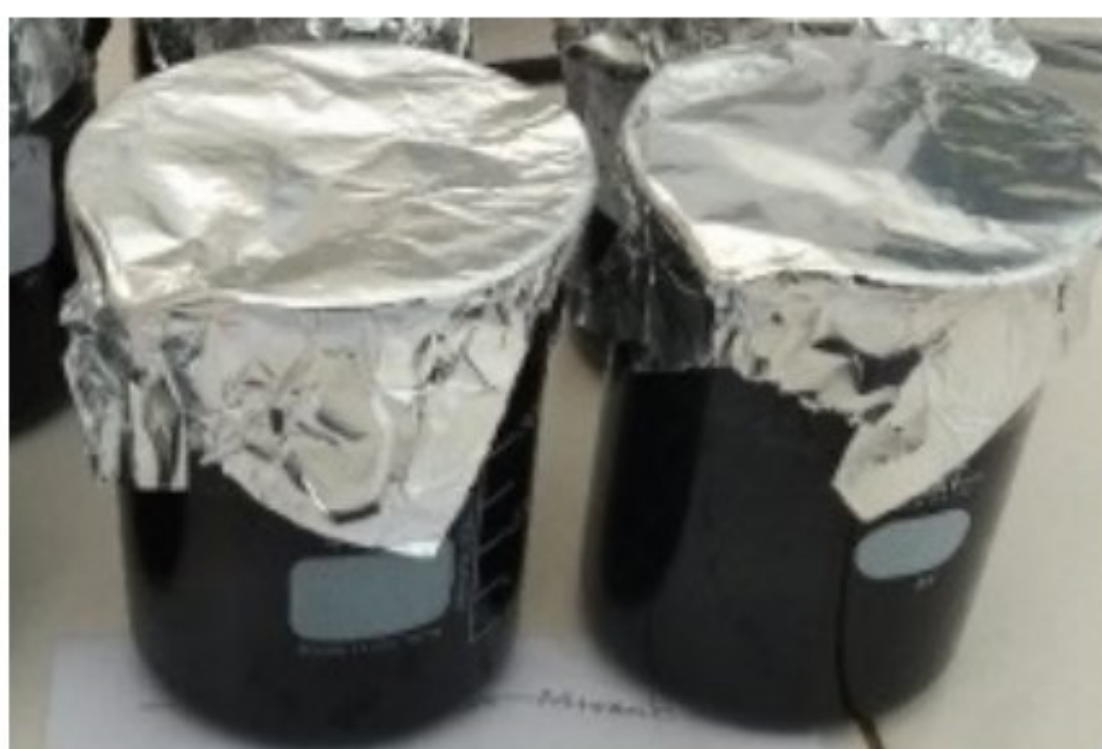
Gambar 5 Perendaman karbon aktif dengan aktivator H 2 SO 4
