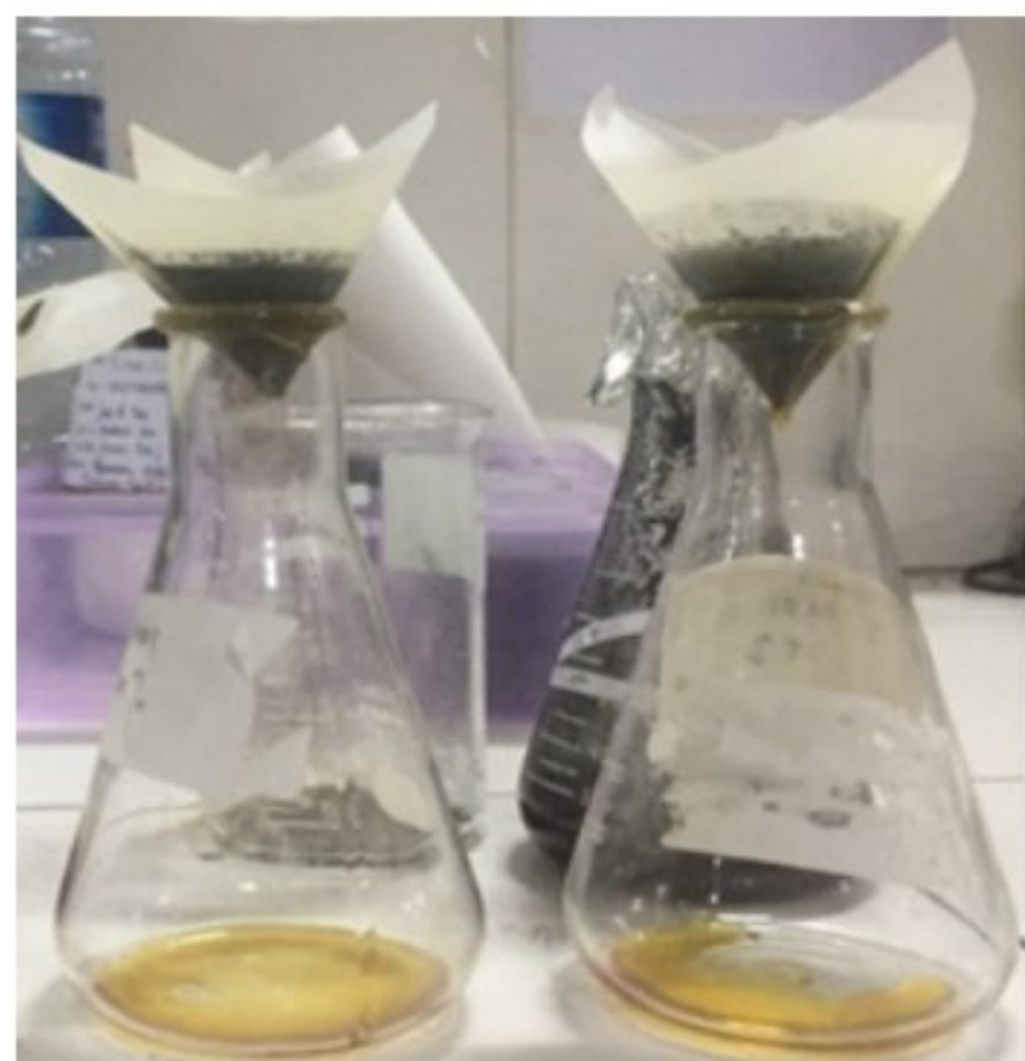
Gambar 9 Penyaringan karbon aktif dan minyak jelantah
