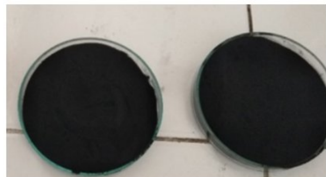
Gambar 7 Karbon aktif yang siap digunakan
