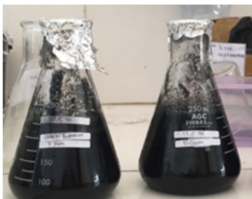
Gambar 8 Perendaman karbon aktif pada minyak jelantah
