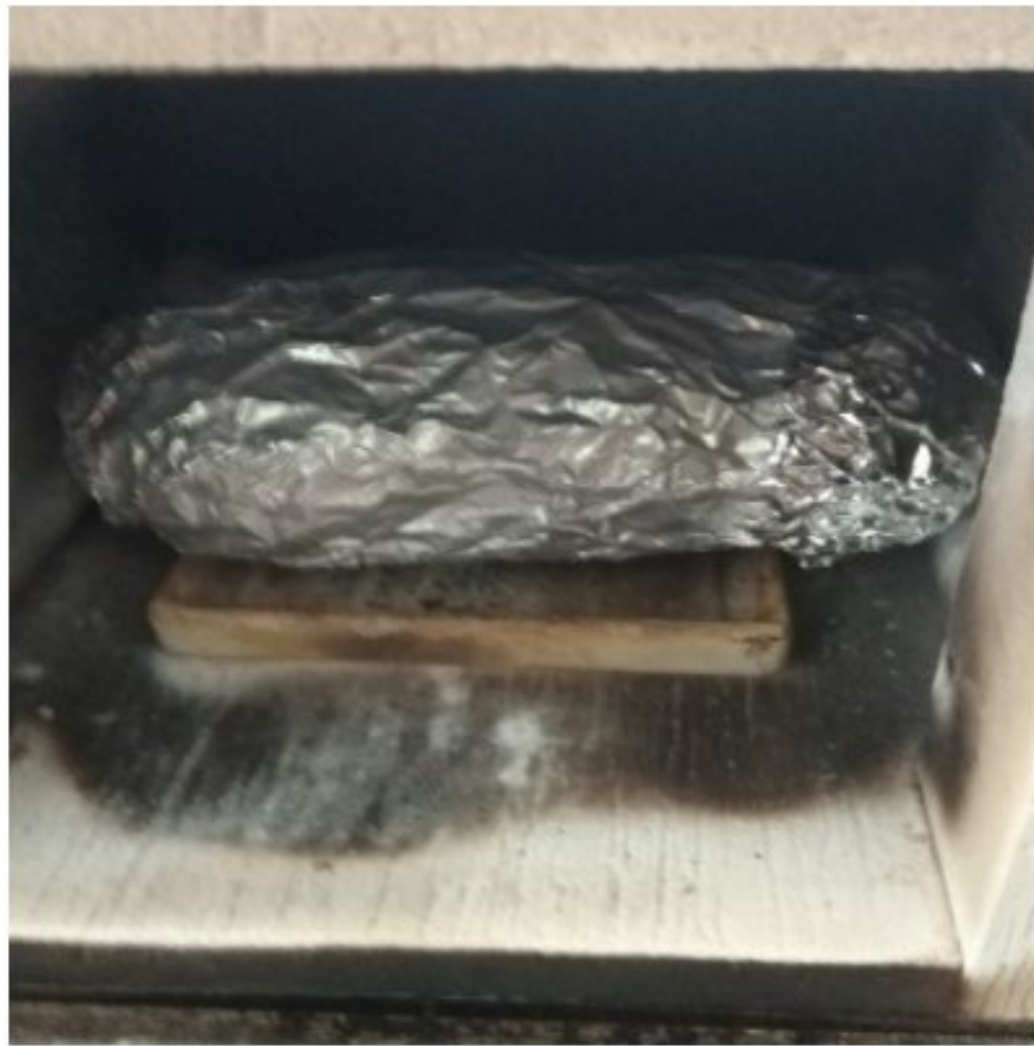
Gambar 3 Karbonisasi ampas tebu didalam furnace
