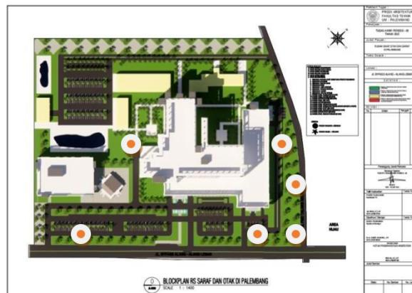
Gambar 4.12 Titik penempatan pilar hydrand
