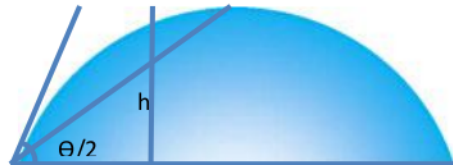
Gambar 6. Ilustrasi dari metode \theta/2 static contact angle
