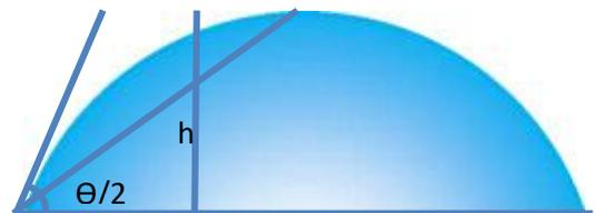
Gambar 6. Ilustrasi dari metode  $\theta/2$  static contact angle
