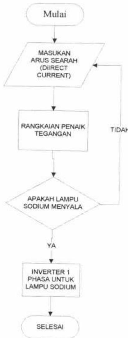
Gambar 3.1 Blok diagram inverter 1 phasa untuk lampu sodium
