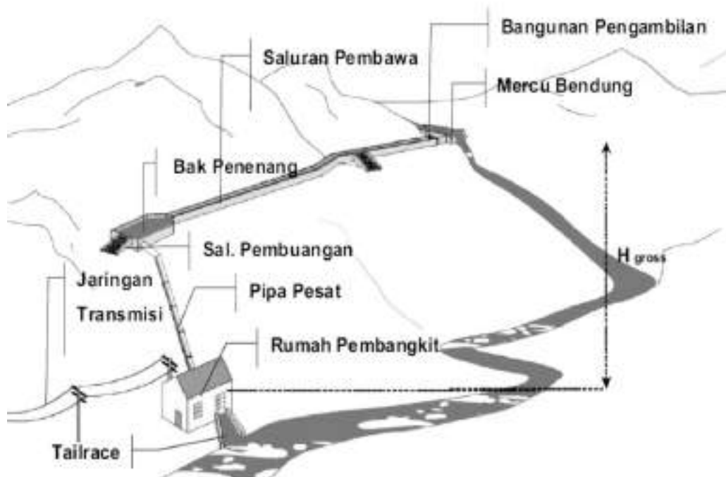
Gambar 20. Situasi Umum PLTMh yang Ditemyui di Indonesia
