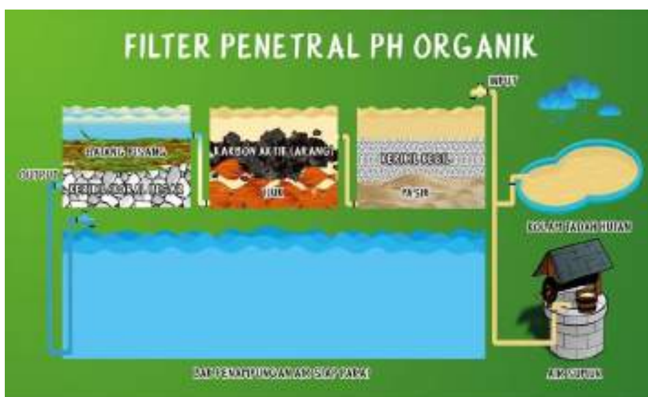
Gambar 9 .Teknologi biofilter penetral pH dengan adsorbsi batang pisang.
