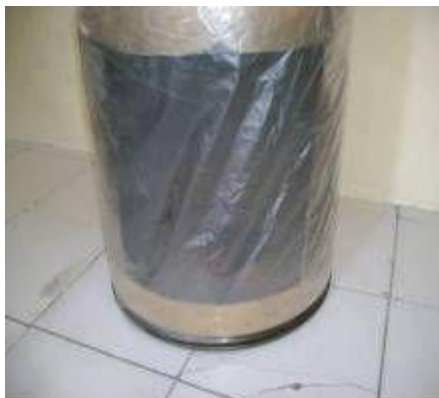
Gambar 7. Ruang uji pada kondisi setelah 15 menit tanpa zeolit
