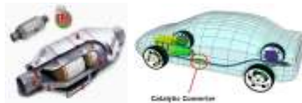
Gambar 1. Gambaran sederhana konverter katalitik pada mobil.
