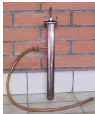
Gambar 8. Reaktor yang Digunakan untuk Uji Reaksi Dekarboksilasi
