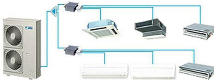
Gambar 4. 23 Sistem Kerja AC VRV
