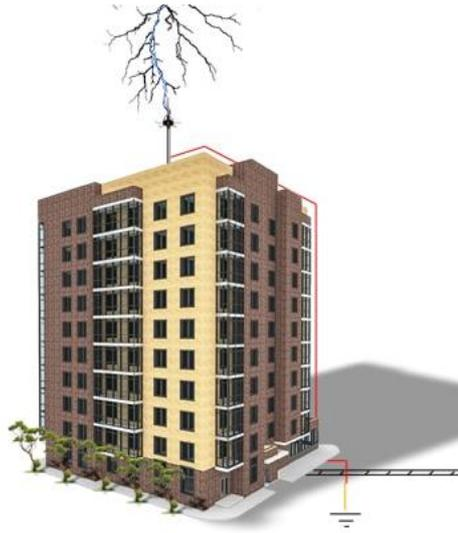
Gambar 2. 25 Sistem Penangkal Petir
