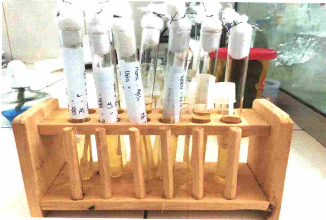
Gambar 1. Sampel Pasien yang sudah di pindahkan dari carry blair ke Luria Broth
