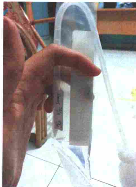
Gambar 16. Memasukkan Air Bersih Ke Dalam Plastik Hingga Air Menyentuh Bagian Bawah Kertas Saring
