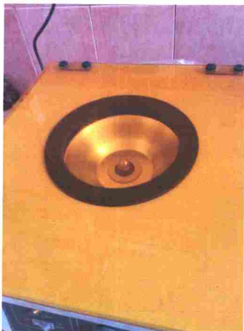
Gambar 19. Sentrifusi 8 Tabung Dengan Kecepatan 3000x/menit Selama 2 Menit Sumber : Lab Basah FK UMP, 2016
