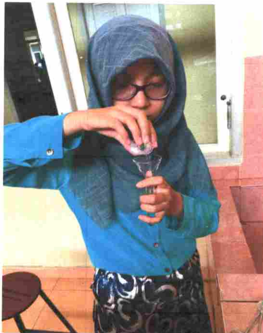
Gambar 19. Memasukkan Potongan Kuku Yang Dicampur dengan 0,25% NaOH ke Dalam Tabung Sentrifus Sumber : Lab Basah FK UMP, 2016
