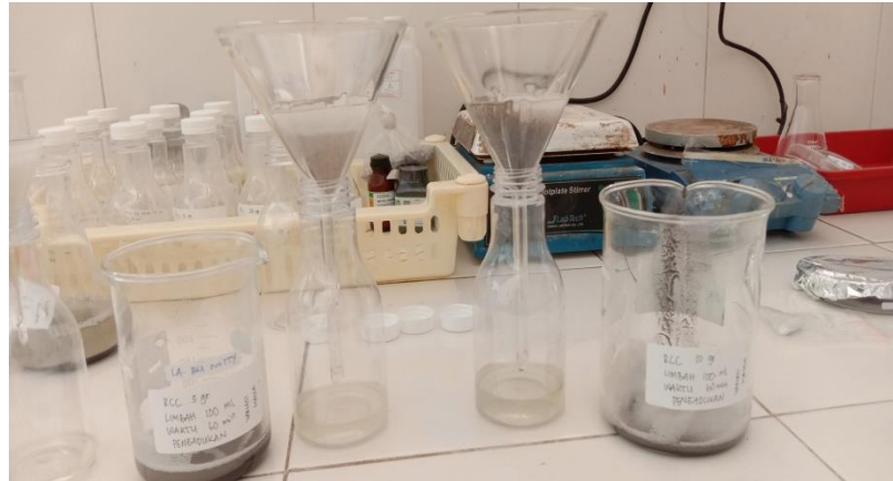
Gambar 3.3 Penyaringan Variasi Massa
