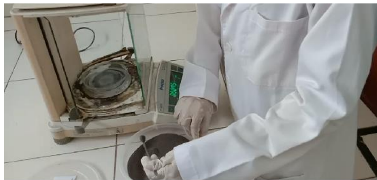
Gambar 3.1 Penimbangan Adsorben 5,10,15,20 dan 25 gr
