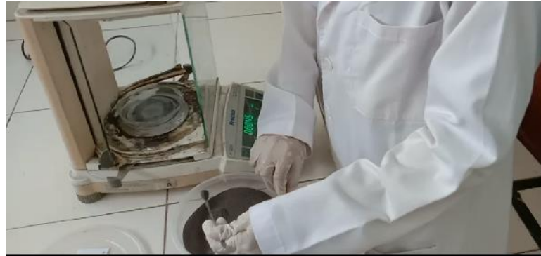
Gambar 2.1 Penimbangan Adsorben 5,10,15,20 dan 25 gr
