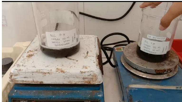
Gambar 3.2.1 Proses Pengadukan pada waktu standar 60 menit
