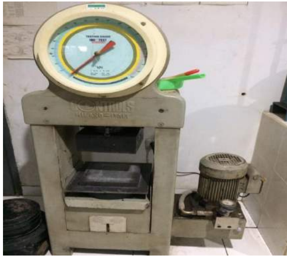
Gambar 3.13 Mesin uji kuat tekan beton
