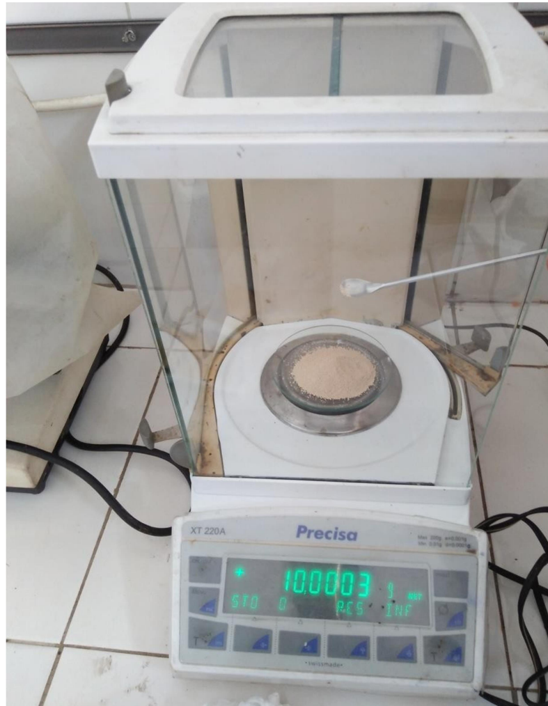
Menimbang massa ragi menggunakan neraca analitik
