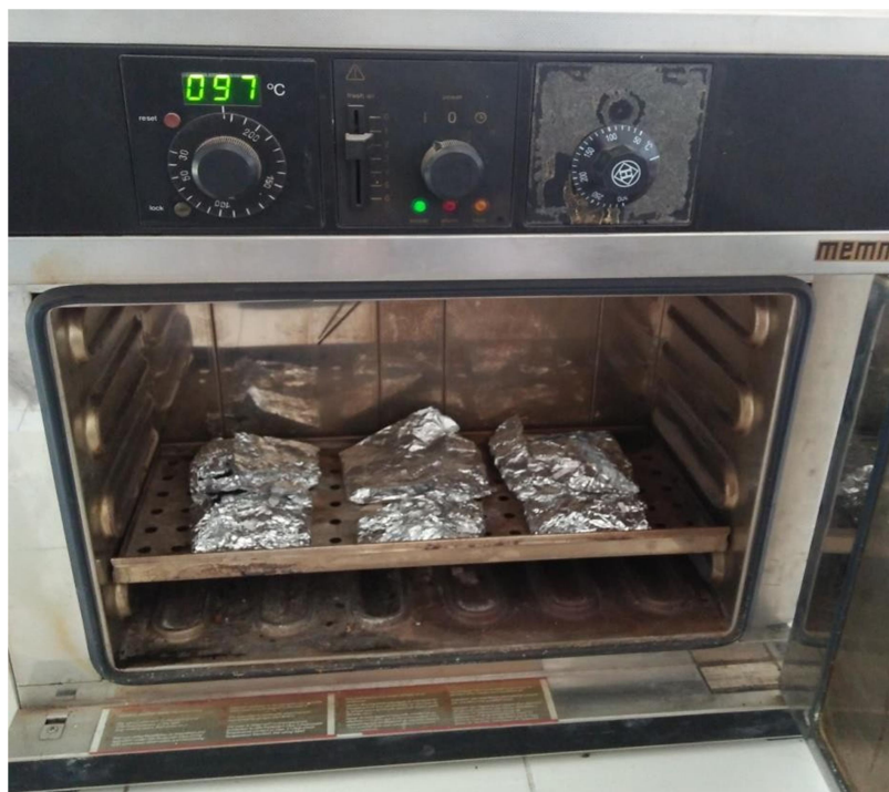
Penghilangan kadar air dengan pemanasan menggunakan oven
