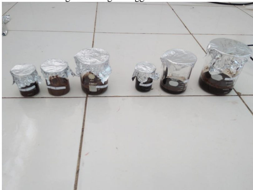
Beberapa sample tanah gambut setelah proses penyaringan
