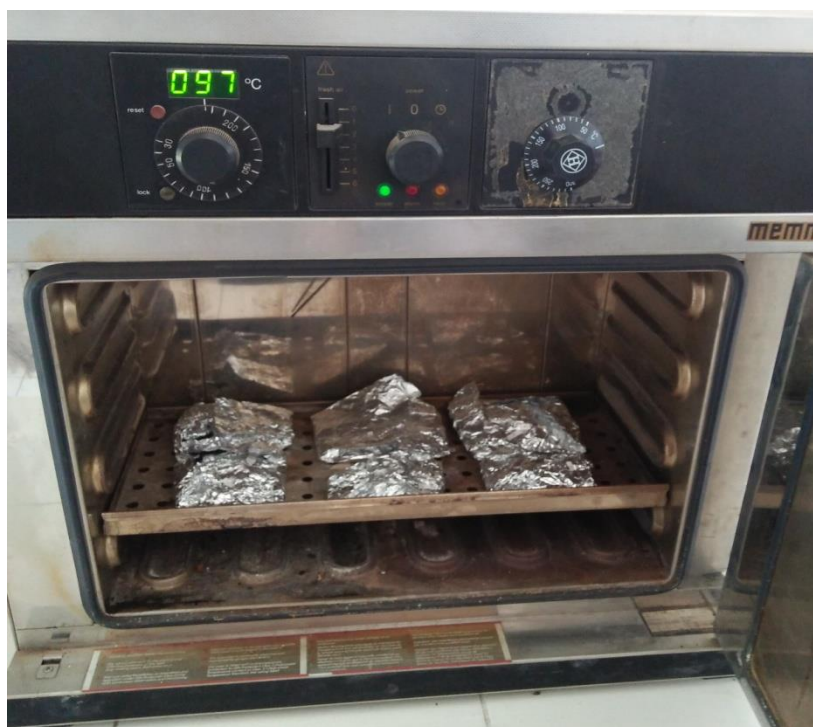
Penghilangan kadar air dengan pemanasan menggunakan oven
