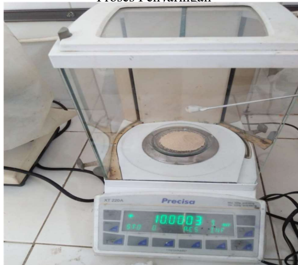
Menimbang massa ragi menggunakan neraca analitik
