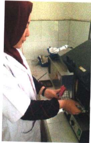
Gambar L.2 Memasukkan cangkang ke dalam furnace
