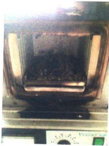
Gambar L.3 Proses Karbonisasi pada Furnace
