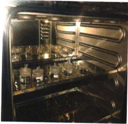
Gambar L.13 Analisa Kadar Air
