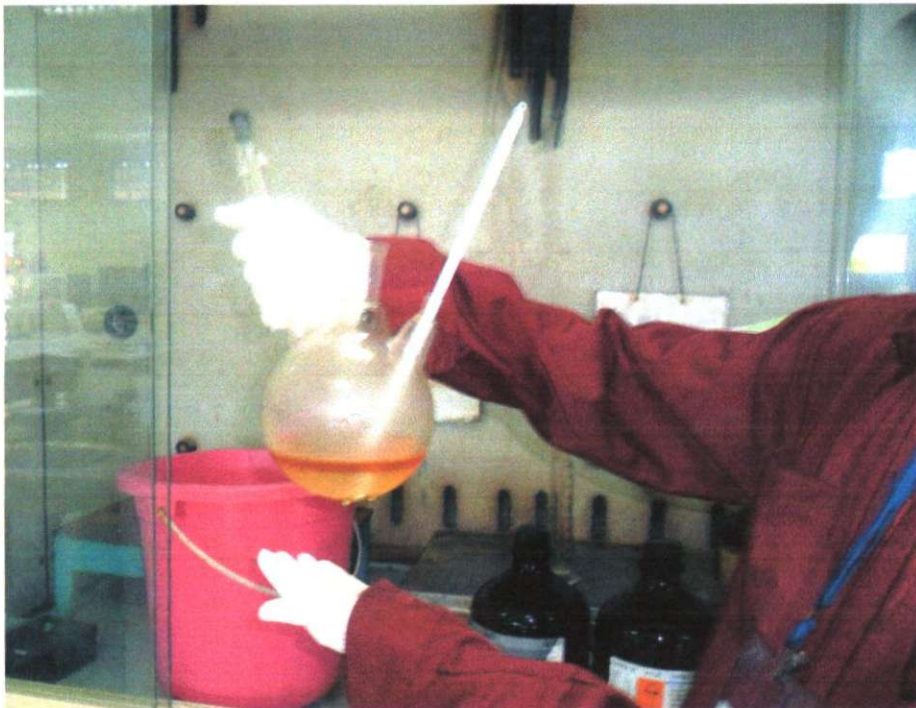
Hasil dari pencampuran larutan \text{H}_2\text{SO}_4 + \text{HNO}_3 dan metil ster didalam wadah es sebelum direfluks
