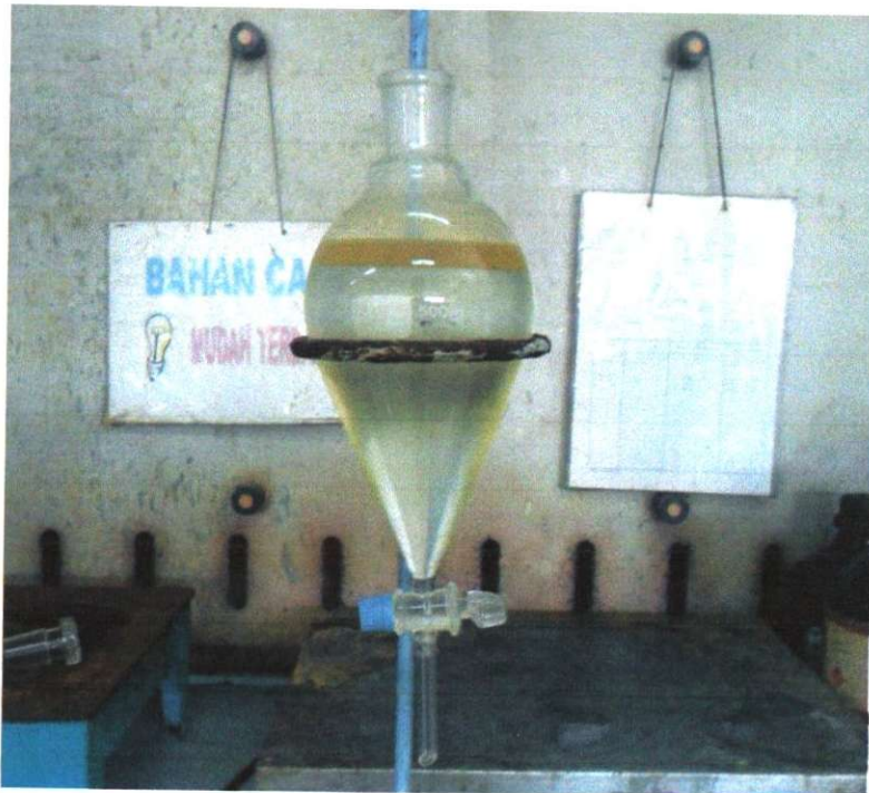
Hasil dari proses refluks antara larutan \text{H}_2\text{SO}_4 + \text{HNO}_3 dan metil ester
