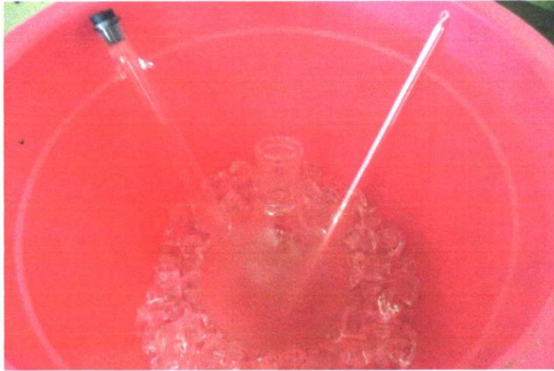
Pencampuran Larutan \text{H}_2\text{SO}_4 + \text{HNO}_3 dan Metil Ester didalam wadah es
