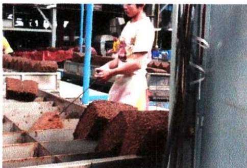
Gambar 12. Proses pembongkaran trolley setelah melalui mesin dryer
