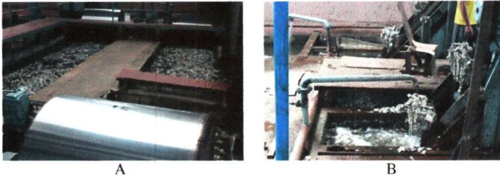
Gambar 3. Bak penampung (A) dan keranjang cedokan (B)
