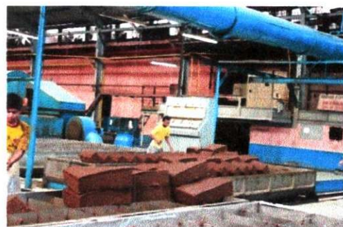
Gambar 12. Proses pembongkaran trolley setelah melalui mesin dryer
