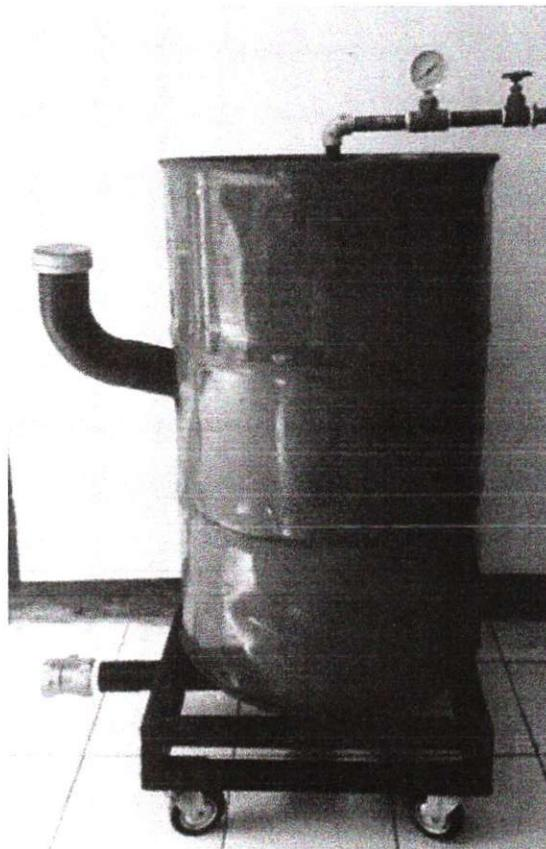
**Gambar 4.1. Reaktor Biogas Hasil Rancangan**
